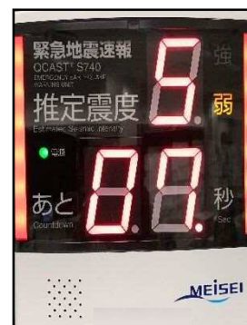
緊急地震速報機器
