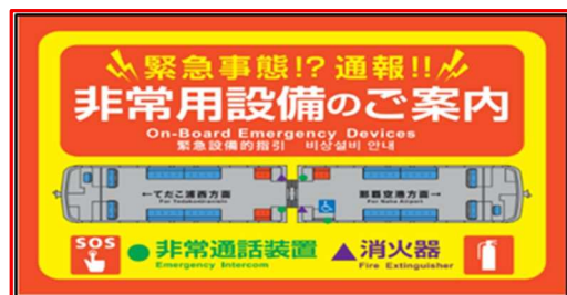
車内非常設備の設置箇所を表示
