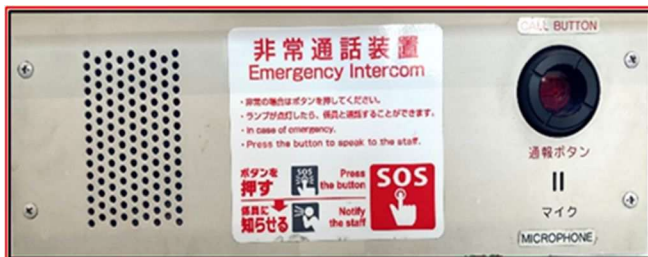
車内非常通報装置
