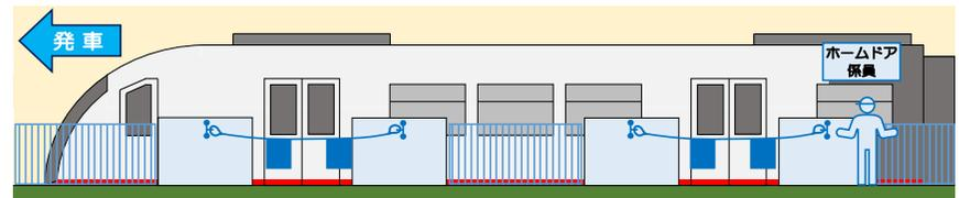
※緊急時には、ホームドア係員が緊急ボタンを作動して、き電を停止します。
