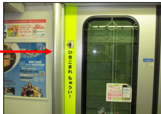
戸袋引き込まれ注意ステッカー
