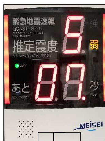
緊急地震速報機器
